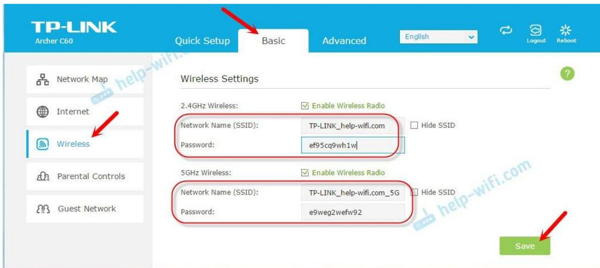
Здесь настраиваем Имя сети (ssid) и пароль. Для работы на каждой частоте задается отдельно.
